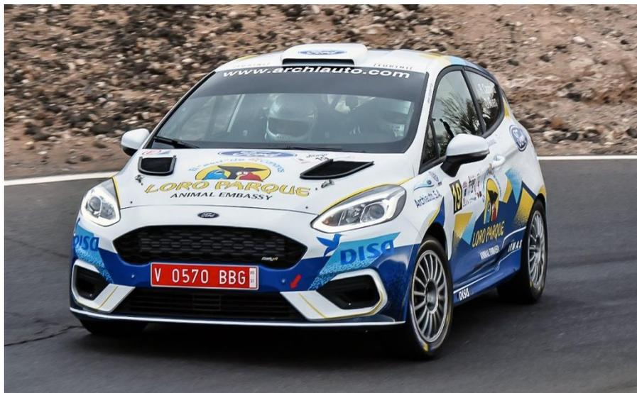
*MOTOR: Turbo alimentado 999cc Tecnología Ford EcoBoost. 12 valvulas, 3 cilindros en línea. Culata de aleación y bloque de acero. Brida de 30 mm FIA.
